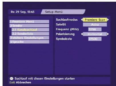
Drücken Sie die Tasten **◀▶**, bis der gewünschte Suchlauf-Typ ('**Premiere Suchlauf**', '**Komplett**' oder '**Frequenz**') angezeigt wird.
