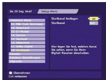
Wenn Sie Ihren Digital-Receiver auf einen bestimmten Kanal einstellen möchten, so wählen Sie mit den Tasten **◀▶** für 'Startkanal festlegen' die Einstellung **an**. Drücken Sie dann die Taste **▼**, um den Programmplatz zu markieren. Löschen Sie nun mit der Taste **◀** den aktuellen Programmplatz und geben Sie mit den **Zifferntasten** den gewünschten Programmplatz ein.
